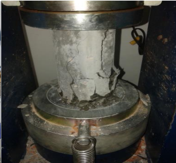
Figura 6: Corpo de prova sendo comprimido.
