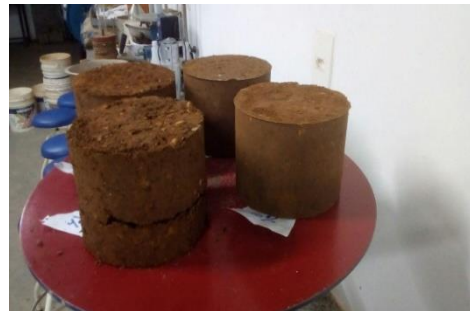
Figura 2: Amostras compactadas com adições de pneus
