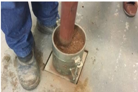
Figura 1: Compactação por camadas
