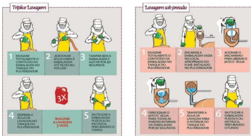
Figura 2 – Procedimento da tríplex lavagem de embalagens vazias de defensivos agrícolas
